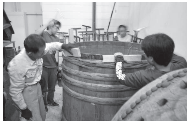
桶の修復・補修
