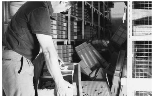
滑落したコンテナの取り出し
