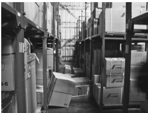
16日本震後 ラックから転倒した段ボール
