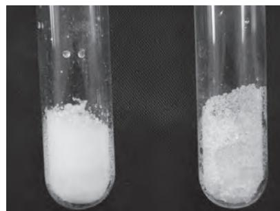
(2) 冷え方による結晶の大きさの違いを実験で調べる。
