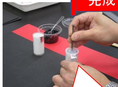
ケースに「フタ」をして、中心部分に「クギ」を差し込めば「活性炭電池」の完成！
