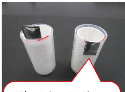
写真のようにサンドイッチを丸め、ケースの中に入れる。アルミの「耳」は外に折り曲げる。
